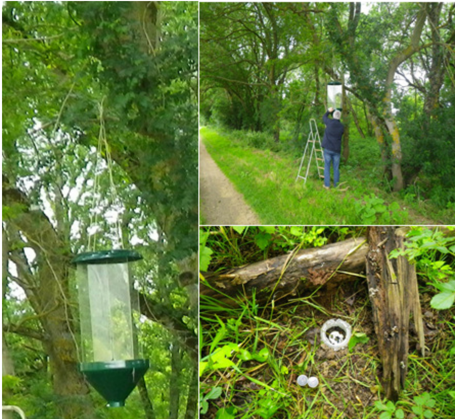
Fig. 28. Installation d'un piège directionnel (en haut à droite), piège installé sans flacon collecteur (à gauche) et piège de type "Pitfall" (en bas à droite). (Clichés de T. Ratz).
